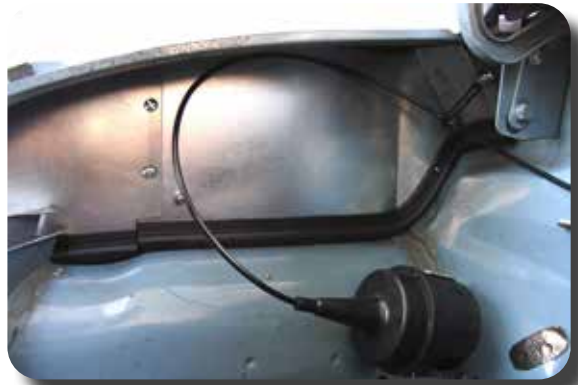
Ventilatorunit zit nu in het rechter voorscherm.
