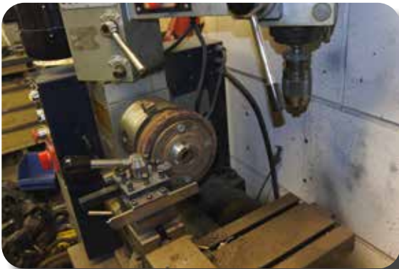
Draaiwerkzaamheden tbv de krukspoelie.
