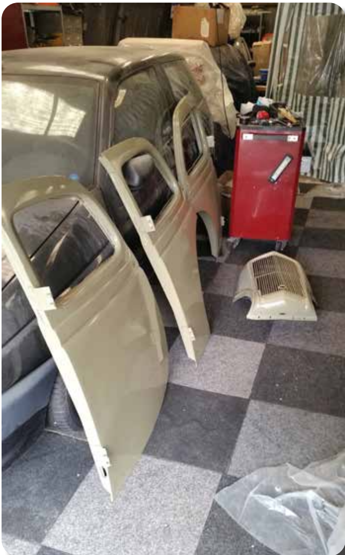
De deuren voorzien van een nieuwe laklaag.
